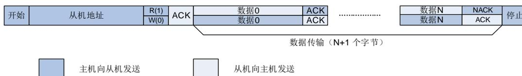
图 17-7. 10 位地址的 I2C 通讯流程（主机发送）
